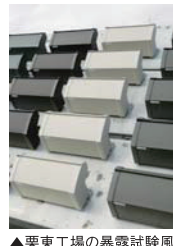
▲東東工場の暴露試験風景（南面35°傾斜）
