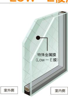
特殊金属膜と中空層のダブル効果で一般複層ガラスの約1.7倍の断熱効果を発揮。夏は太陽の日射を抑え、室内の冷房効果を高めます。冬は太陽熱を取り込みながら、室内の熱を逃がしません。
